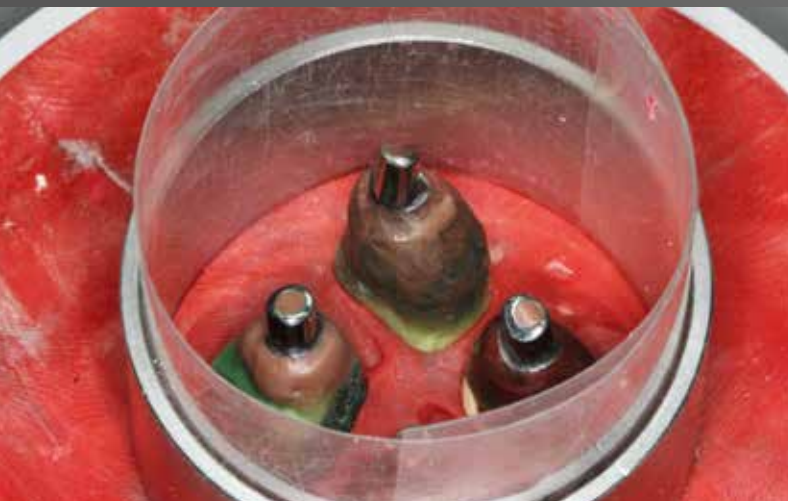
07 Für die Anfertigung von Galvano-Sekundärteilen wurden die Stümpfe für die Duplierung vorbereitet
