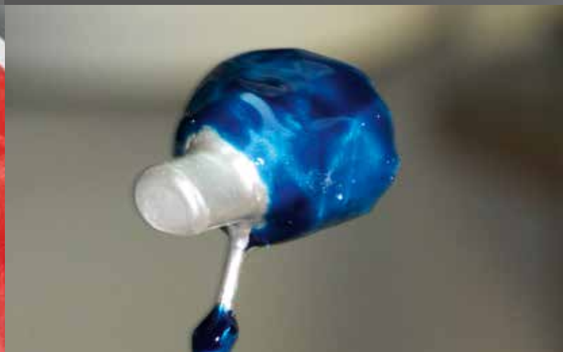
08 Die Duplikatstümpfe aus Kunststoff wurden mit Silberleitlack und Elektroden versehen, sodass sie im Galvanogerät platziert werden konnten
